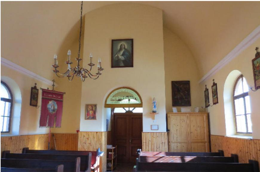
Die Decke des Kapellenraumes ist mit einer Holzkonstruktion als Tonnengewölbe ausgeführt.
